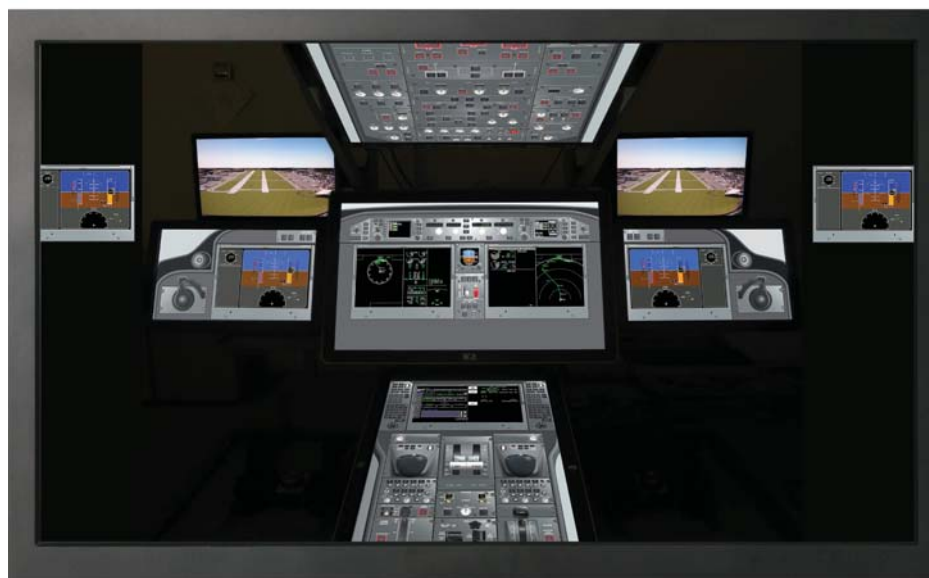
Макет кабины MS-21 (ФГУП «ГосНИИАС»)
