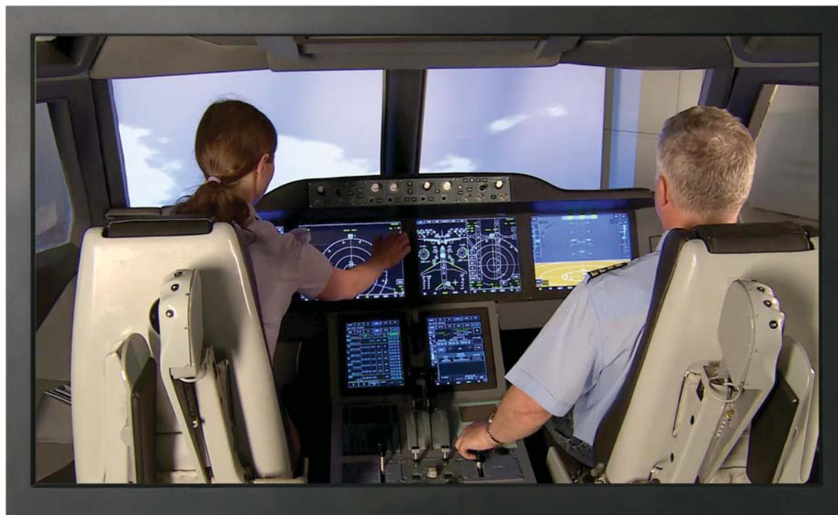
Валидация и демонстрация перспективных бортовых процедур на макете кабины перспективного воздушного судна (ФГУП «ГосНИИАС», ФГУП «ПИЦ»)
