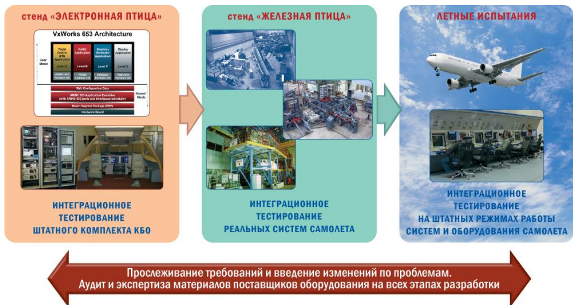
Рис. 2.15. Процессы интеграции на уровнях интегратора системы ИМА и разработчика самолета.
