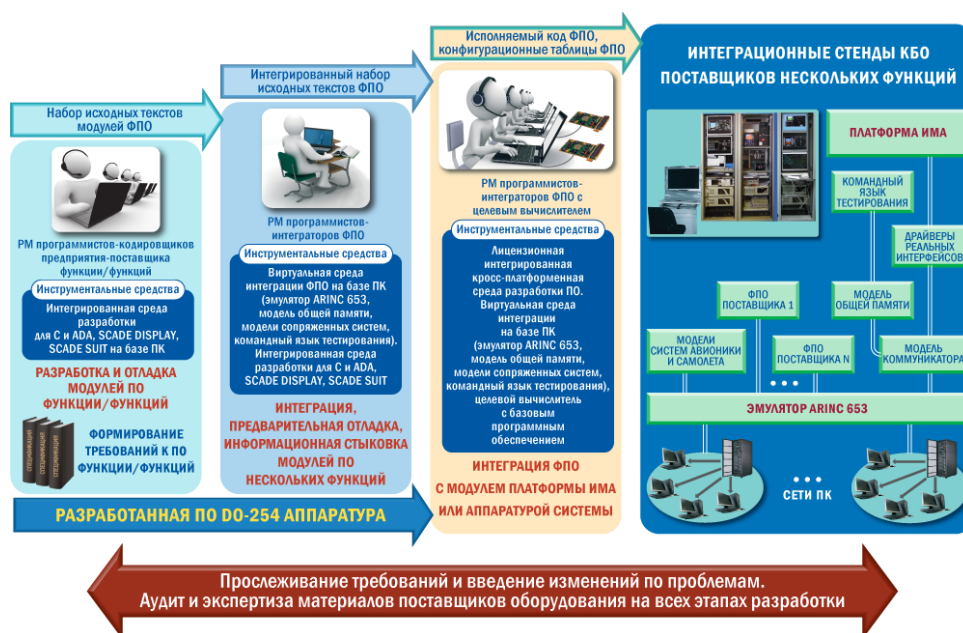
Рис. 2.14. Процессы интеграции на уровне разработчиков ПО и аппаратуры.
