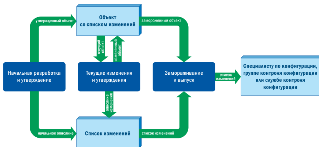
Рис. 3.12. Общая структура процесса управления конфигурацией.
