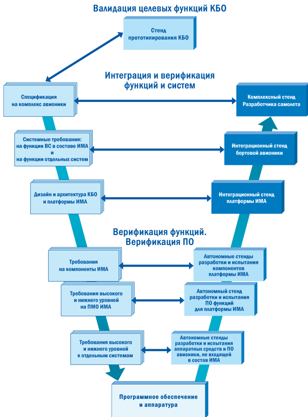
Рис. 3.11. Типовой состав стендовой базы КБО.
